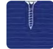
Unsere RAPID® Hardwood setzt neue Maßstäbe am Schraubenmarkt und bietet erstmals eine Verschraubung in Hartholz OHNE Vorbohren.
