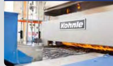
In unserer neuen Wärmebehandlungsanlage härten wir die Schrauben in spezieller Gasatmosphäre.
