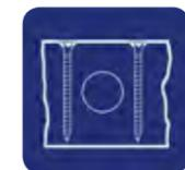
Neu zugelassen ist die Anwendung unserer Premium-Schrauben als Querkzugverstärkung oder Auflagerverstärkung, bei Durchbrüchen von Trägern etc. Weiters können unsere Schrauben z.B. in Träger mit Rissen als Schubverstärkung eingesetzt werden.
