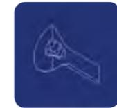
Der optimierte „T-Antrieb“ erleichtert das Verschrauben, da die Schraube durch die spezielle Form des Bits besser geführt ist und somit leichter mit einer Hand verschraubt werden kann.
