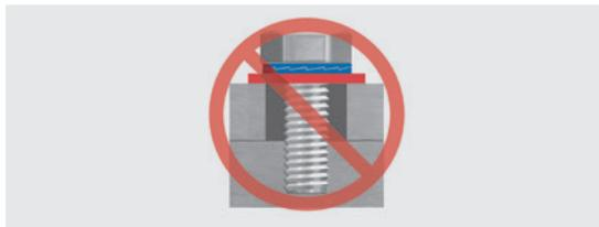
Für den Einsatz bei Langlöchern, auf weichen Materialien oder beschichteten / lackierten Oberflächen eignen sich die Nord-Lock Sicherungsscheiben mit vergrössertem Aussendurchmesser (sp/spss) in Verbindung mit Flanschschrauben oder Flanschnuttern.
