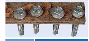
ecosyn®-MRX Bohrschrauben nach 1500 Stunden Test im Salzsprühnebel: von Kopf bis Spitze frei von Korrosionsspuren
