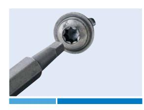
Der steckbare Innenachtkant-Antrieb ist mit handelsüblichen Vierkant-Bits zu verarbeiten. Durch die konische Antriebsform des Bits bleibt die Schraube unverlierbar am Werkzeug stecken (4-Kant Bit 1/4" BN 10318)
